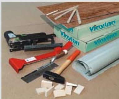
**1** Alles bereit? PE-Folie und Klebeband. Als Werkzeug: Zollstock, Bleistift, Stichsäge, Fuchsschwanz, Fäustel, Setzlatte, Zugeisen, Schlagholz und Abstandskeile.
