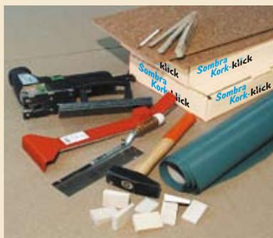
**1** Alles bereit? PE-Folie und Klebeband. Als Werkzeug: Zollstock, Bleistift, Stichsäge, Fuchsschwanz, Fäustel, Setzlatte, Zugeisen, Schlagholz und Abstandskeile.
