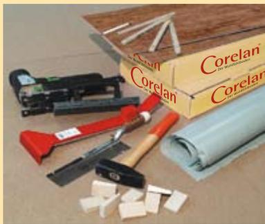
**1** Alles bereit? PE-Folie und Kleband. Als Werkzeug: Zollstock, Bleistift, Stichsäge, Fuchsschwanz, Fäustel, Setzlatte, Zugeisen, Schlagholz und Abstandskeile.
